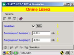
Sie können nun zu Testzwecken Ausgangsströme bzw. Ausgangsspannungen vorgeben. Drücken Sie Enter, um die numerische Vorgabe wirksam werden zu lassen.
